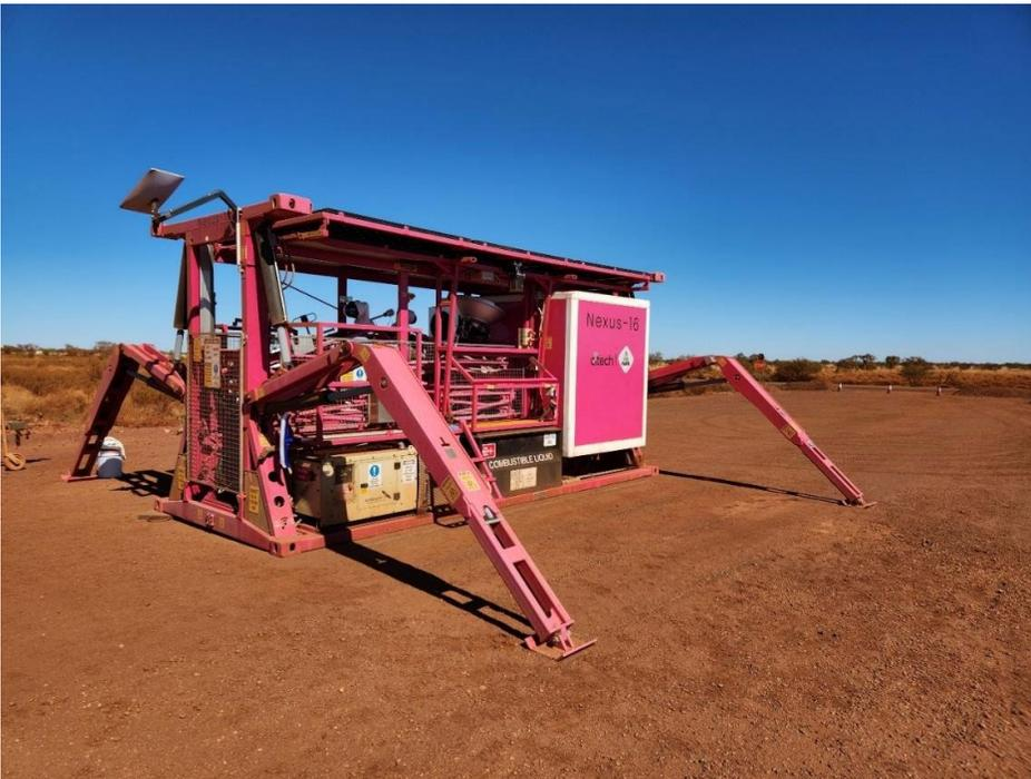
Nexus 16 im "Schildkrötenmodus" bereit für den Aufprall - Das System ist gesichert und eingefahren und wartet auf den Aufprall des Zyklons.
